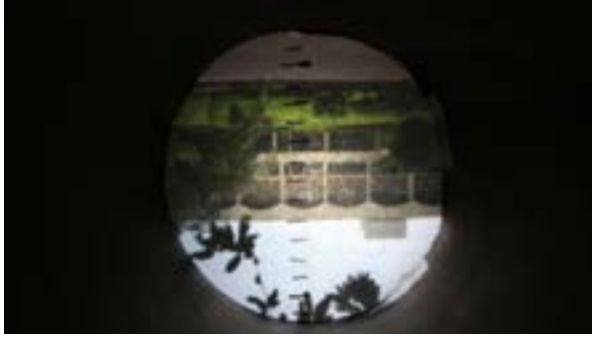
आकृती 6(ब) सूचिछिद्र कॅमेऱ्यात वस्तूची उमटलेली प्रतिमा Figure 6(b) Image in pinhole camera
